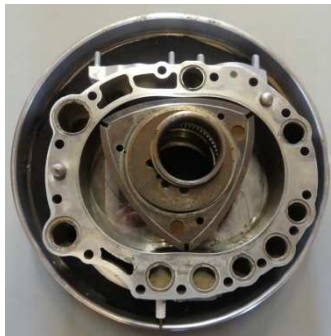
Le principe du moteur Rotatif "Wenkel", présenté par Thierry.
